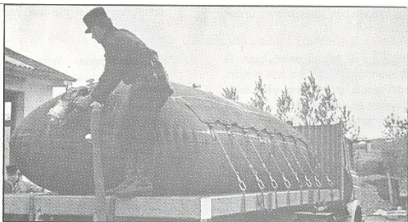
Rajah 17: Tangki pengangkutan fleksibil berkeupayaan 10,000 liter/2222 gelen. (Plate 17) Diletakkan di atas kenderaan. Ia juga boleh digunakan sebagai simpanan sementara.
