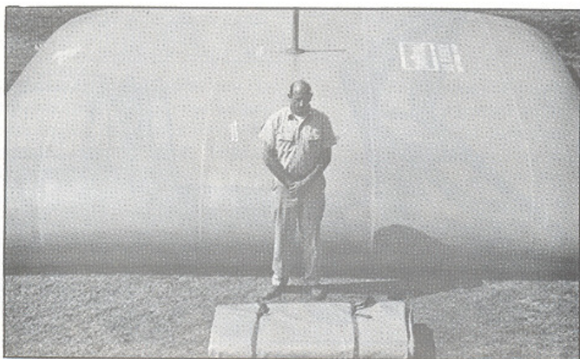
Rajah 24: Tangki penyimpanan yang fleksibil untuk instalasi bahanapi. Ia boleh (Plate 24) digulung dan diangkut apabila kosong.
