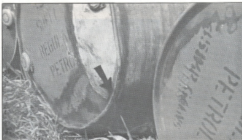
Rajah 7: Dram-dram yang telah dikendalikan dengan lasak menyebabkan kebocoran dan kehilangan minyak menjadi punca utama kebakaran. (Plate 6)
