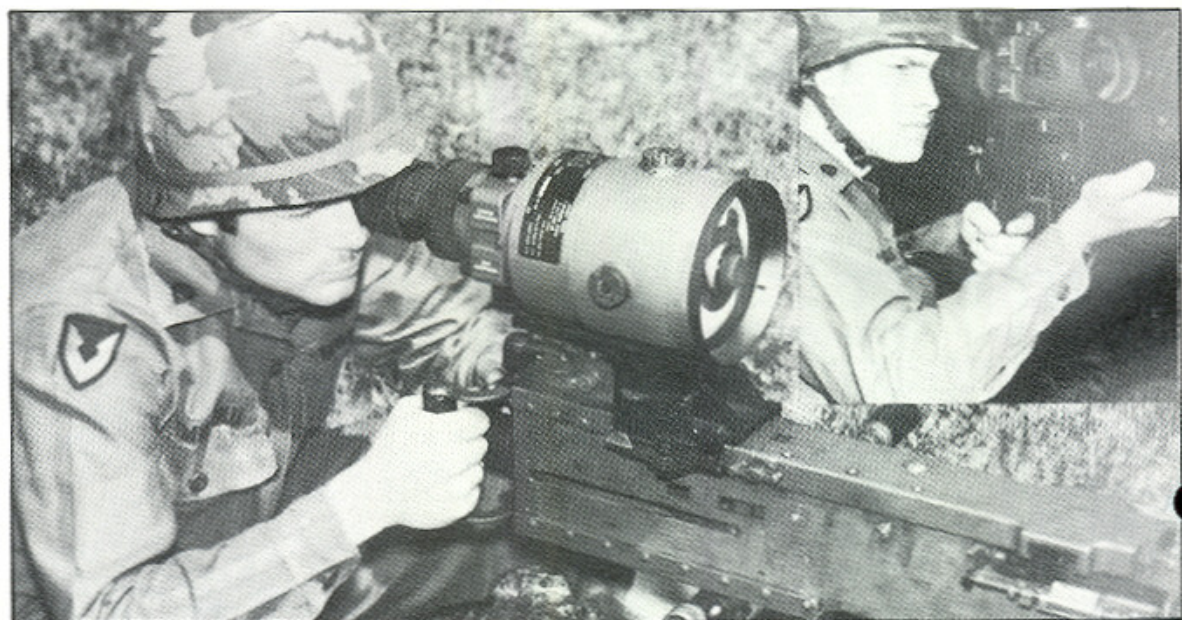
Contoh Pengamat Imej (Image Intensifier) yang digunakan sebagai teropong pejera malam kepada senjata.
